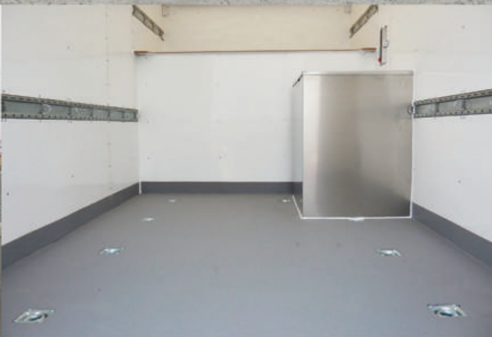
Plancher recouvert de Line-X avec enclages au plancher et boîtier de génératrice
