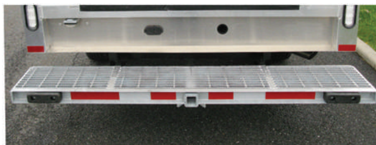
Pare-choc de modèle pleine largeur, extra robuste, entièrement galvanisé à chaud avec attache de remorque encastrée
