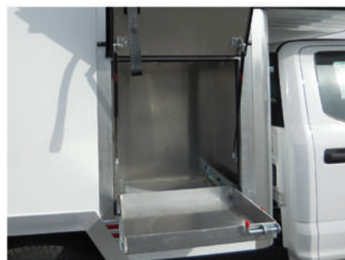
Porte de côté avec plateau installé sur glissières
