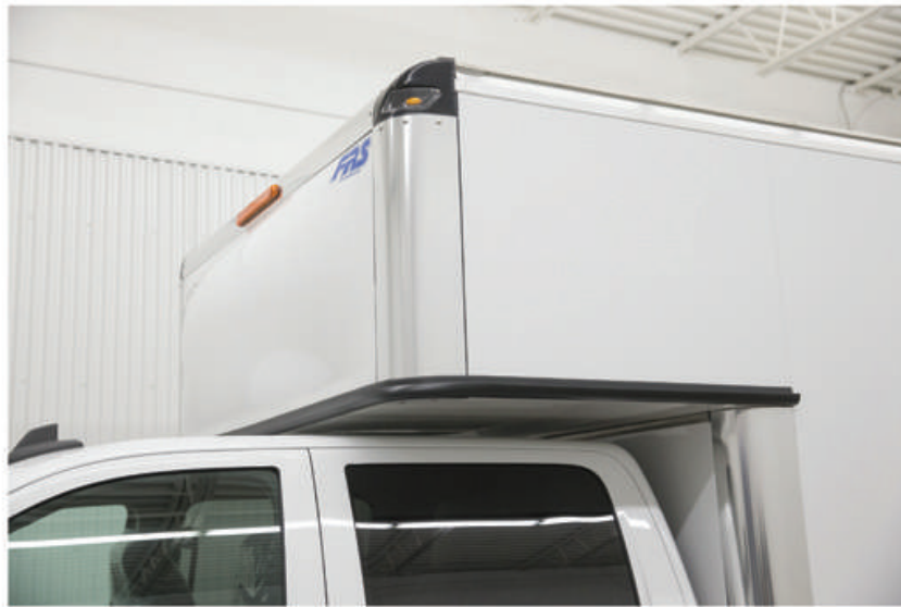
Allonge de cabine de 42" avec déflecteur d'air intégré
