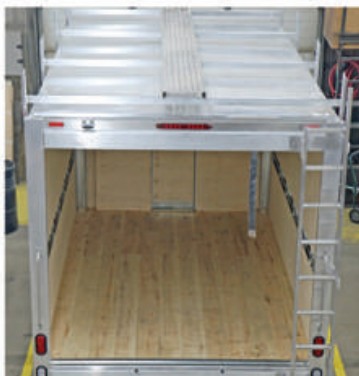
Support à échelle arrière et passerelle sur le toit
