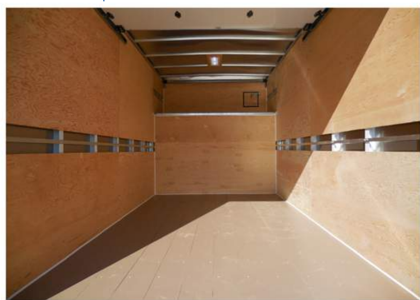
Intérieur avec barres d'attaches Modèle fer plat
