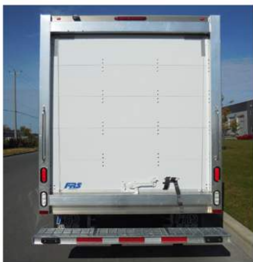
Porte arrière de type roulement vertical "Roll-Up" entièrement recouverte d'aluminium
